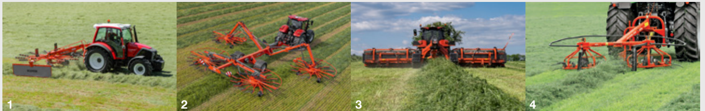
1. Angebaute Einkreiselschwader - 2. Aufgesattelte Vierkreiselschwader - 3. Bandschwader - 4. Universalheumaschinen
