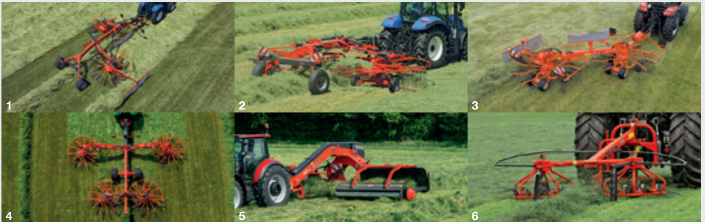
1. Aufgesattelte Zweikreiselschwader mit Seitenablage - 2. Aufgesattelte Zweikreiselschwader mit mittlerer Ablage - 3. Gezogene Zweikreiselschwader - 4. Vierkreiselschwader - 5. Bandschwader - 6. Universalheumaschinen
