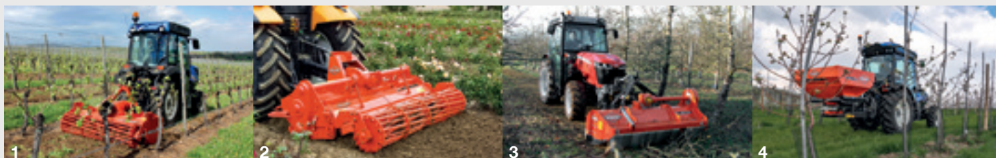
1. Kreiselegen - 2. Rotorfräsen - 3. Mulchgeräte - 4. Düngerstreuer
