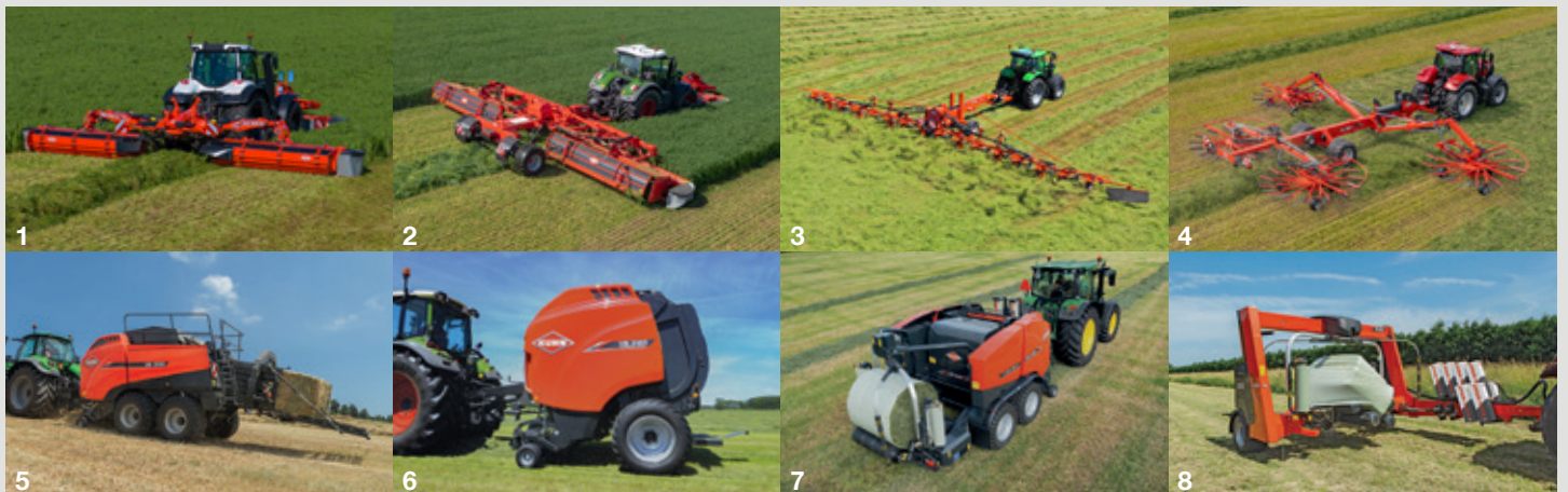
1. Faucheuse triple - 2. Faucheuse-conditionneuse triple - 3. Faneur grande largeur - 4. Andaineur 4 rotors - 5. Presse à haute densité - 6. Presse à balles rondes - 7. Presse combinée - 8. Enrubanneuse.
