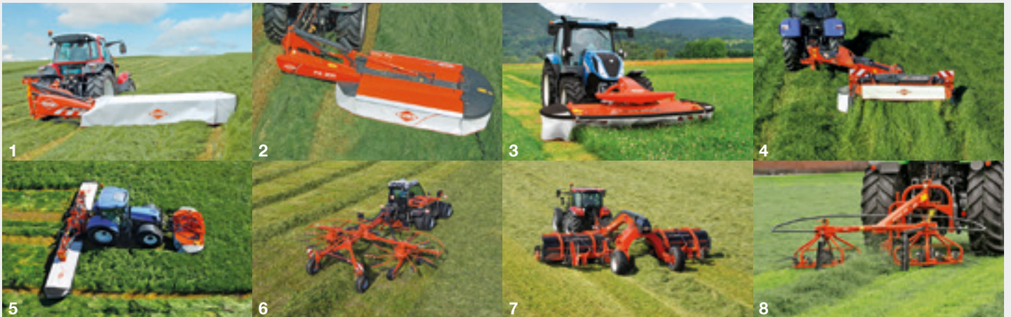
1. Heck-Scheibenmäher - 2. Heck-Trommelmäher - 3. Front-Scheibenmäher und Mähaufbereiter - 4. Gezogene Scheibenmäher und Mähaufbereiter - 5. Dreifach-Mähkombinationen - 6. Giroschwader - 7. Bandschwader - 8. Universalheumaschinen
