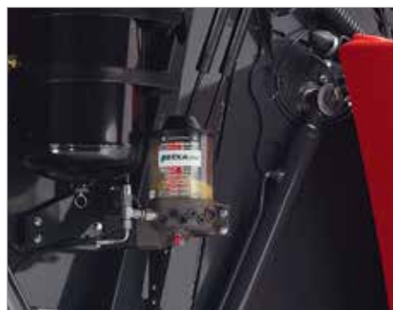
10. Serienmäßige automatische BEKA-MAX Zentralschmierung
