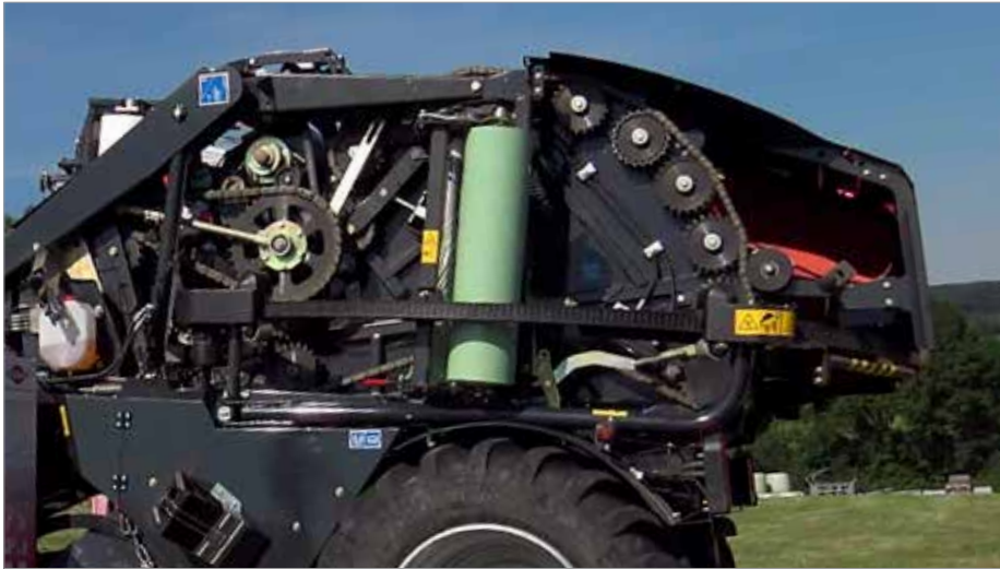
1. Robuster Antrieb mit hochwertigen IWIS-Ketten
