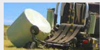
Ballendreher (legt Ballen auf flacher Seite ab)
