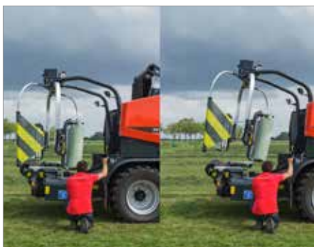
8. VBP 7190: Integrierte Verstellung des Wicklers zum Durchladen von Ballen größer als 1,60 m
