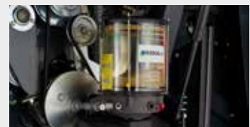
Zentralschmierung mit 4 kg Vorrat
