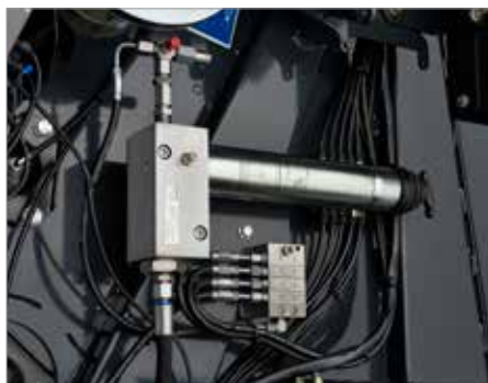
5. Serienmäßige automatische BEKA-MAX Zentralschmierung für die Walzenlager
