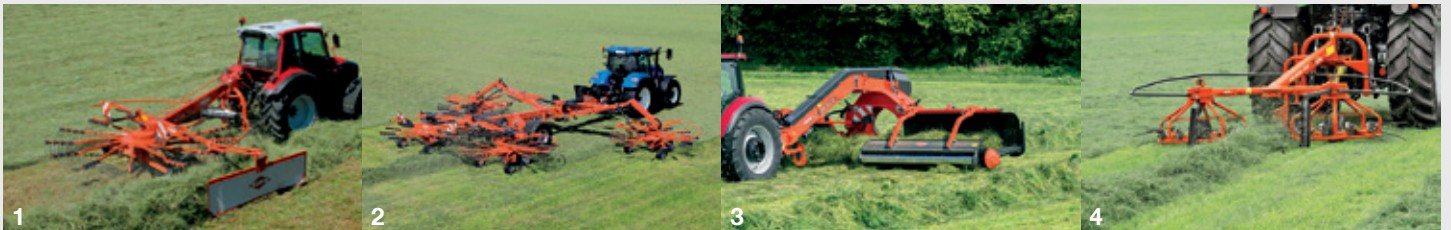
1. Anbauschwader mit einem Kreisel - 2. Aufgesattelte Vierkreisel-Schwader - 3. Bandschwader - 4. Universalheumaschinen
