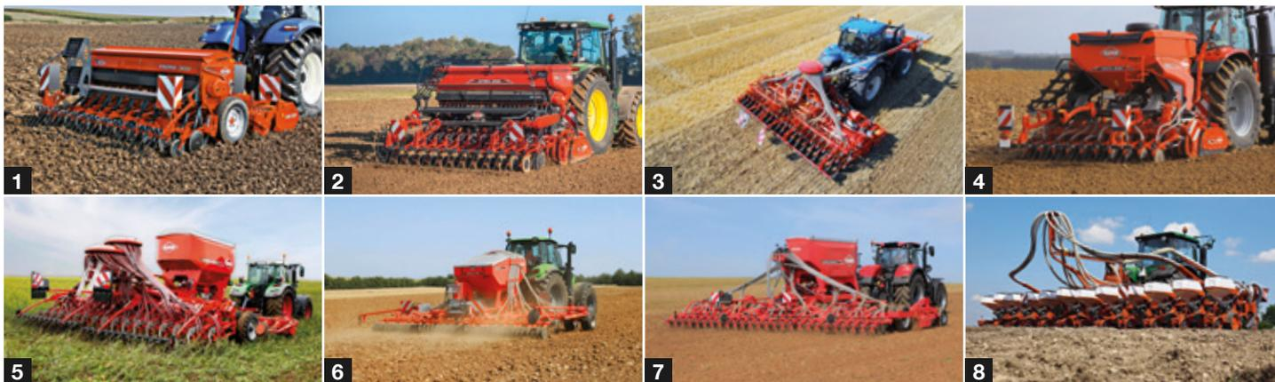
1. mécaniques portés 2. mécaniques intégrés 3. avec trémie frontale 4. intégrés pneumatiques 5. traînés pneumatiques 6. portés pour semis simplifiés 7. traînés pour semis simplifiés 8. monograines
