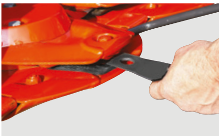
FAST-FIT Messerbefestigung: Die Messer können sehr schnell ausgetauscht werden.
