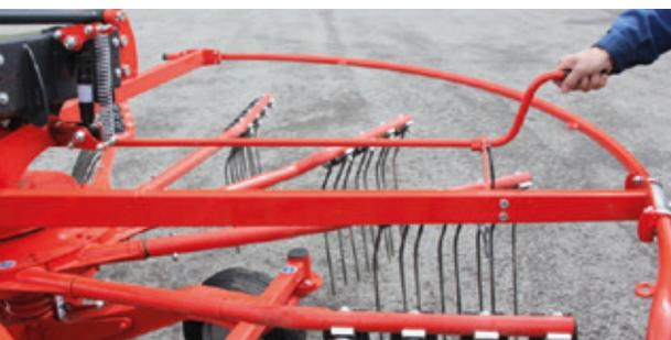
Über eine leicht zugängliche Spindel wird die Rechhöhe an jedem Rotor eingestellt.
