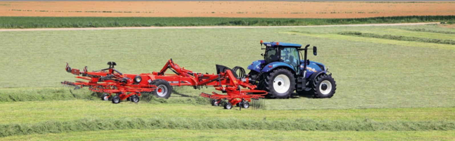
Bedienen Sie die Maschine direkt über die Traktor-Steuergeräte. Das Ein-/Ausklappen, Arbeitsbreite und Schwadbreite lassen sich einfach über drei Steuergeräte und einen drucklosen Rücklauf bedienen.
