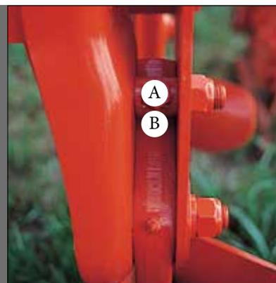
Die Lösung: Durch Verwendung von Abreissbolzen tritt keine Scherwirkung auf.
