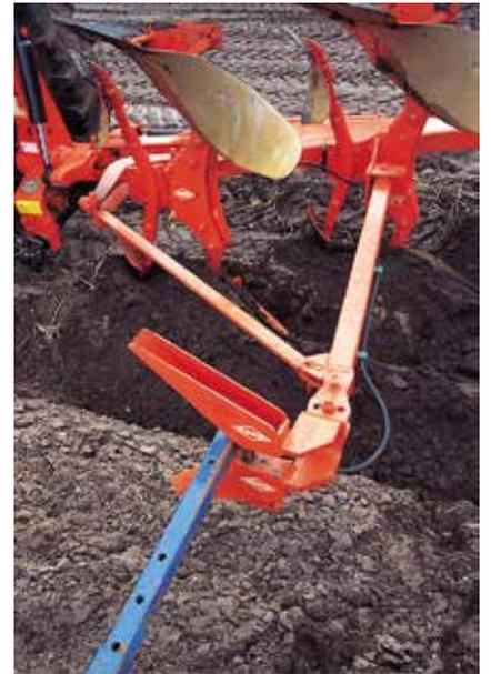
Der seitlich am Pflug befestigte Packerarm ermöglicht den Einsatz eines Pflugnachläufers einschließlich der hydraulischen Ausklinkung am Vorgewende. Eine Anfahrfederung dämpft harte Schläge beim Einfangen des Packers.
