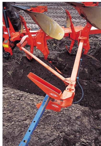
Disponible sur l'ensemble de la gamme MASTER, le bras offre la possibilité d'utiliser un rouleau plombeur traîné grâce à un système d'accrochage simple et de décrochage hydraulique.
