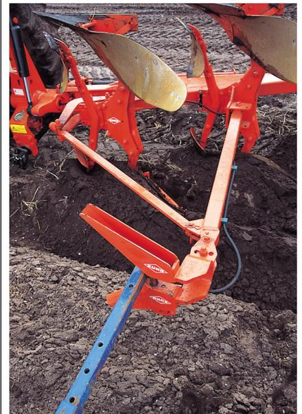
Disponible sur l'ensemble de la gamme MASTER, le bras offre la possibilité d'utiliser un rouleau plombé traîné grâce à un système d'accrochage simple et de décrochage hydraulique.
