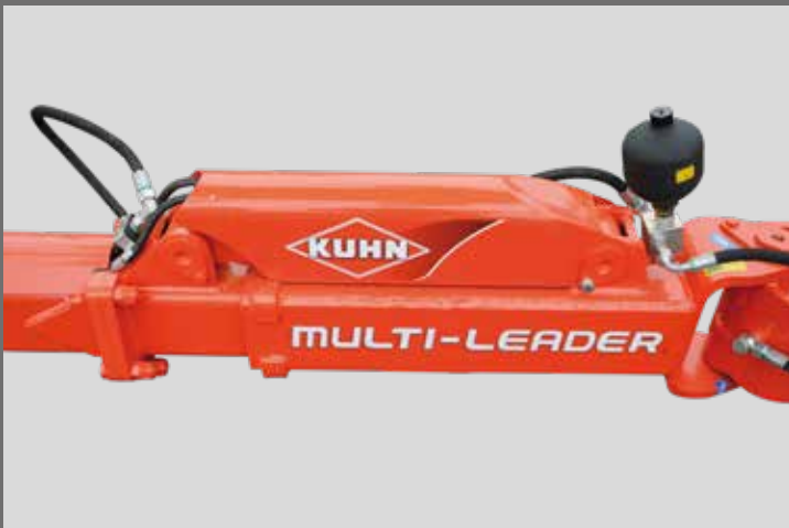
3. Déport : par tirant mécanique ou vérin hydraulique (en option) permet un ajustement à des entre pneu de 1,15 à 1,60 m. Un indicateur visible depuis le poste de conduite facilite le repérage pour un réglage précis
