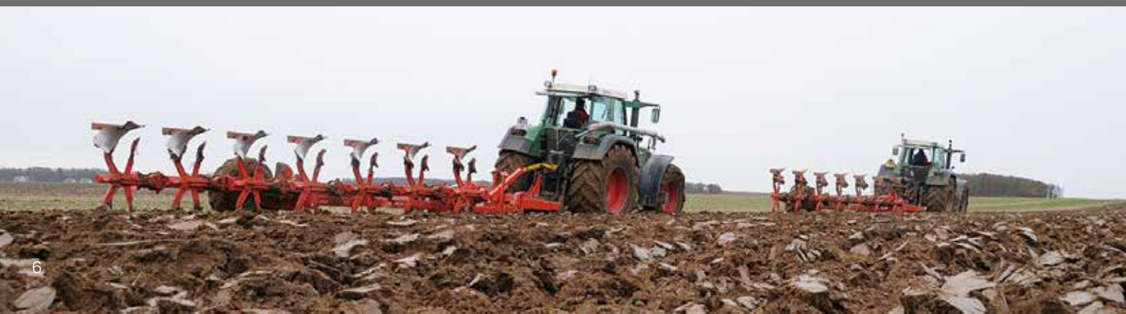
3. Déport : par tirant mécanique ou vérin hydraulique (en option) permet un ajustement à des entre pneu de 1,15 à 1,60 m. Un indicateur visible depuis le poste de conduite facilite le repérage pour un réglage précis
