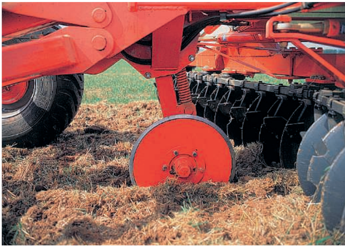
ROHRWALZE Ø 550 - 75 kg/m
