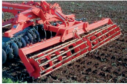
ROHRWALZE Ø 550 - 75 kg/m
