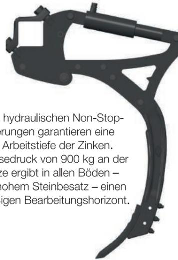
Die neuen hydraulischen Non-Stop-Steinsicherungen garantieren eine konstante Arbeitstiefe der Zinken. Der Auslösedruck von 900 kg an der Scharspitze ergibt in allen Böden – auch bei hohem Steinbesatz – einen gleichmäßigen Bearbeitungshorizont.
