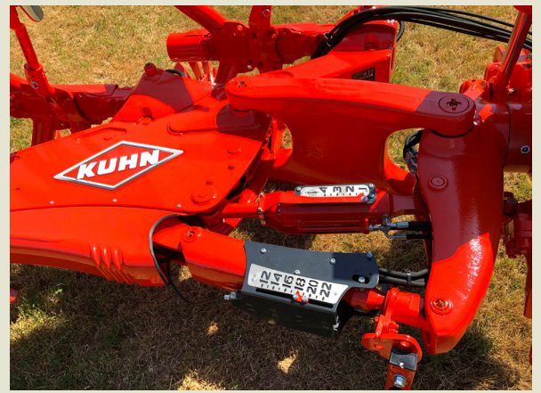
Die Einstellvorrichtung Pro-Set garantiert eine schnelle Inbetriebnahme des VARI-MASTER L.
