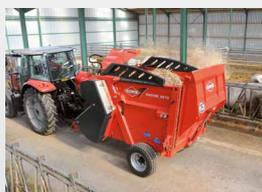
Comme pour la PRIMOR 5570 M, le modèle 3570 M est équipé d'un système de régulation amovible. En version hydraulique en option, il devient possible par simple actionnement de la commande électrique d'adapter la position des peignes régulateurs :
