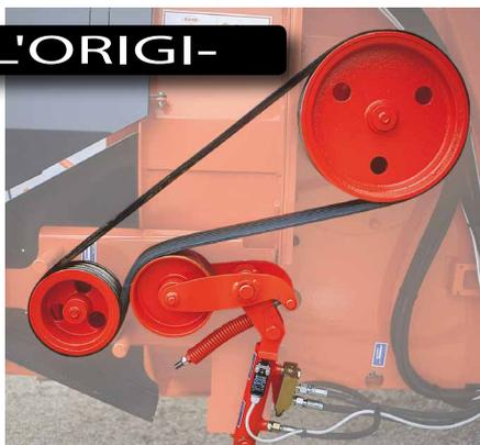
L'entraînement POLYDRIVE du démêleur est une transmission à courroie débrayable hydrauliquement qui offre de nombreux avantages dont :
