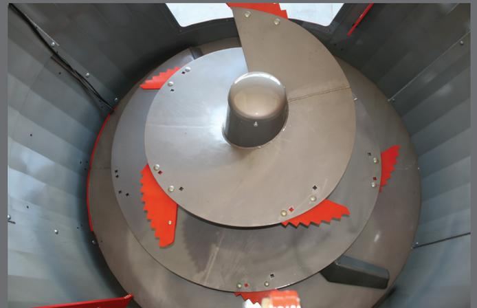
L'ensemble de la vis (spires et tronc de vis) est en K-NOX. L'organe complet est ainsi protégé. La vis est plus résistante à la friction des fourrages et aux acides gras des ensilages.
