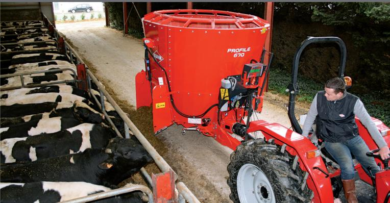
Disponibles en 4 et 6 m<sup>3</sup>, cette mélangeuse PROFILE à une vis verticale est une excellente porte d'accès vers une alimentation gérée des troupeaux. A ce titre, la pesée programmable est un équipement de série. Elle permettra à son utilisateur de charger avec précision chacun des composants de la ration.
