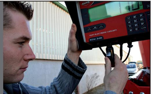
Pour plus de confort, le rappel d'affichage KDR 300 sera disposé dans le tracteur chargeur pour relayer l'information du boîtier principal KDW 341 et ce, avec une portée de 90 m.
