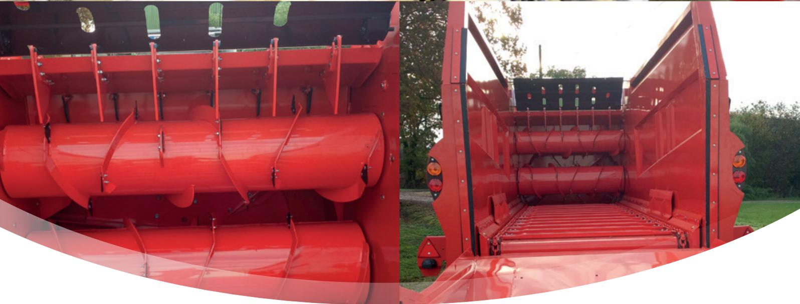
Der PRIMOR 15070 M ergänzt die Baureihe der Universalwagen mit großem Fassungsvermögen zum Einstreuen und zum Verteilen aller Futterarten. **Er kann bis zu vier Quaderballen 1,30 m x 1,20 m x 2,70 m bzw. drei Rundballen mit bis zu 2 m Durchmesser aufnehmen.**
