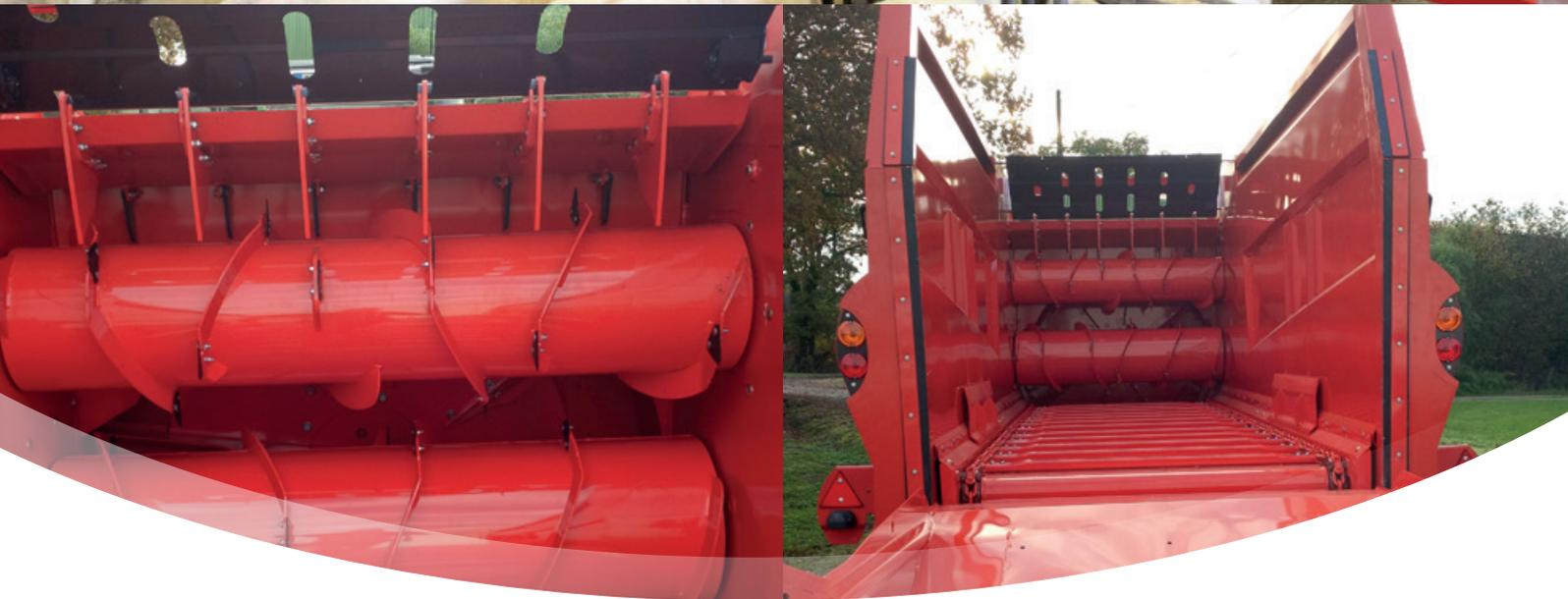
La PRIMOR 15070 M complète la gamme des pailleuses distributrices tout fourrage avec une grande capacité. Elle est dimensionnée pour charger **jusqu'à 4 balles cubiques de 2.70 x 1.30 x 1.20 m** ou **3 balles rondes jusqu'à 2 m de diamètre** (avec l'option UNROLL-SYSTEM).
