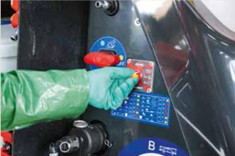
Die Bedienzentren DILUSET und e-SET sind serienmäßig mit einem System ausgerüstet, das den Behälter automatisch bis zum Erreichen der vorgegebenen Spritzflüssigkeitsmenge befüllt. Der Vorteil von e-Set: Der Fahrer muss nicht mehr in die Traktorkabine steigen, denn er bekommt die gewünschte Flüssigkeitsmenge direkt am Bedienzentrum angezeigt.
