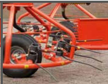
Fourches actionnées par la force centrifuge
