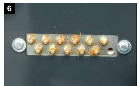
6 Zentral angeordnete Schmierbänke für die Walzenlager
