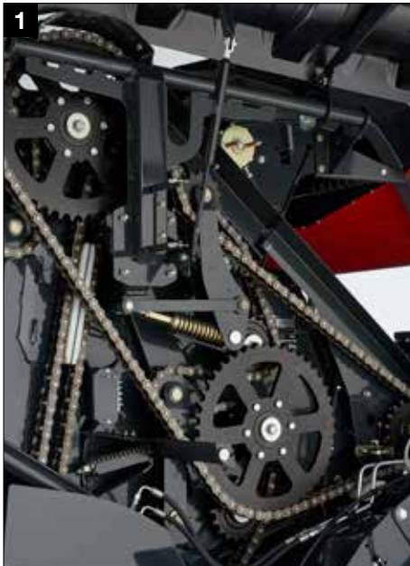
1 Robuster Antrieb mit hochwertigen IWIS-Ketten
