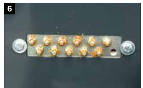
6 Zentral angeordnete Schmierbänke für die Walzenlager
