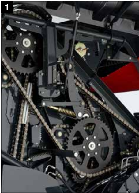
1 Robuster Antrieb mit hochwertigen IWIS-Ketten
