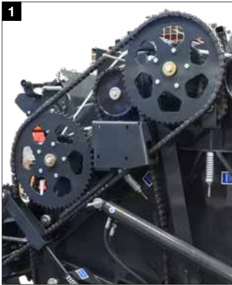
Einfacher Antrieb mit nur 3 Hauptketten
