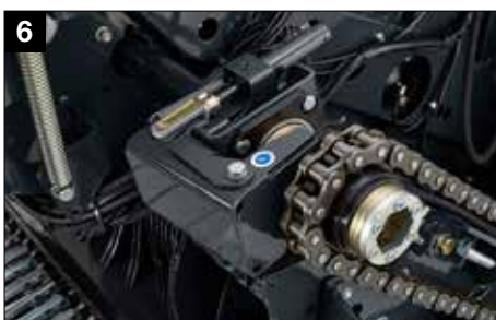
Serienmäßige hydraulische Rotorenkopplung
