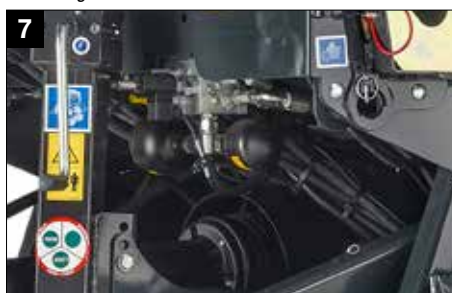
Serienmäßiges Proportionalventil für die Dichteregelung aus der Fahrerkabine
