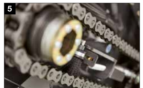
5 Stabile und breite Ölbürsten für optimale Kettenschmierung
