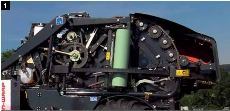
1 Robuster Antrieb mit hochwertigen IWIS-Ketten
