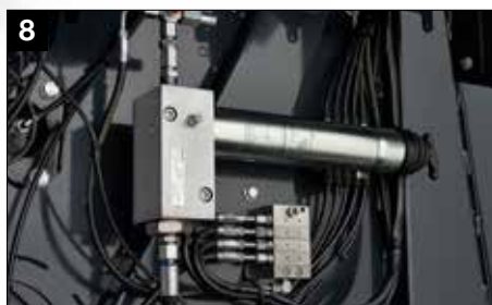
Serienmäßiges automatisches Schmiersystem für die Walzenlager
