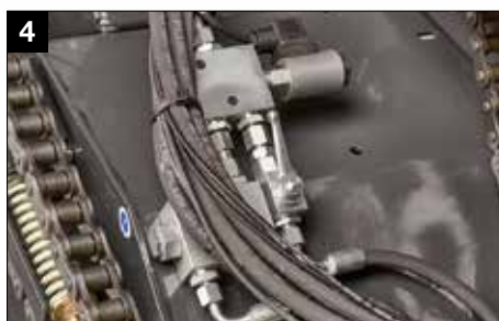
Separate Messerabschaltung/ SCHNEIDBODENABSENKUNG vom Fahrersitz aus
