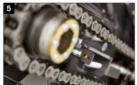
Stabile und breite Ölbürsten für optimale Kettenschmierung
