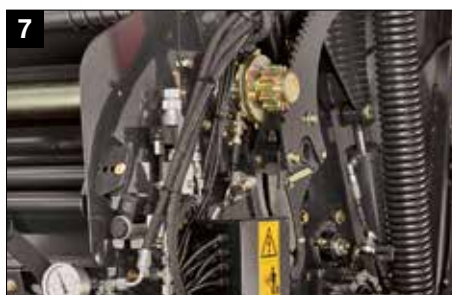
7 Proportionalventil für die Dichteregelung aus der Fahrerkabine
