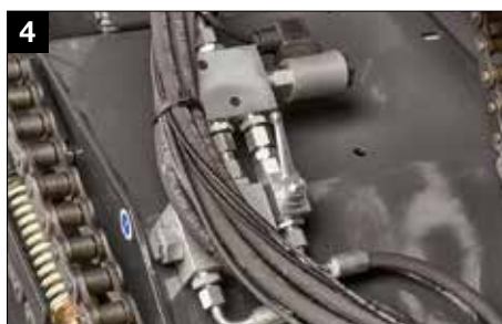
4 Serienmäßige separate Messerabschaltung/ SCHNEIDBODENABSENKUNG vom Fahrersitz aus
