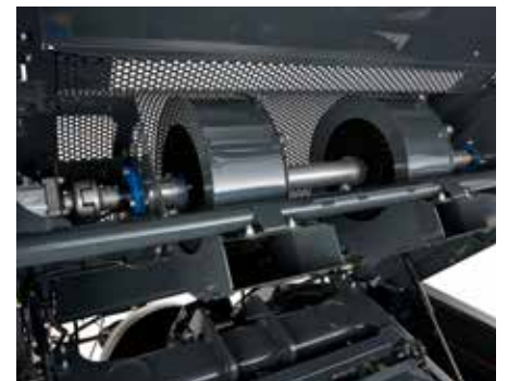
6. Turbinengebläse für Knoterreinigung
