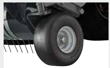
Halbpneumatische schwenkbare Pickup-Tasträder
