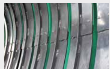
EasyFlow-Platten in der Vorpresskammer
