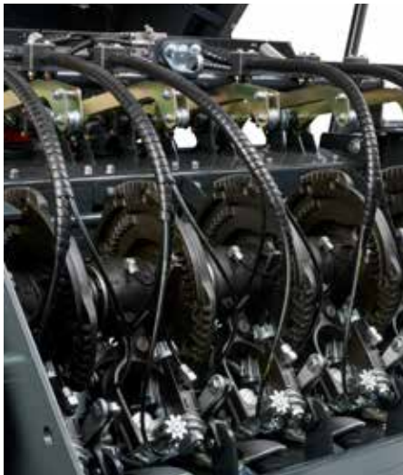
1. Doppelknotersystem mit serienmäßiger elektronischer Überwachung
