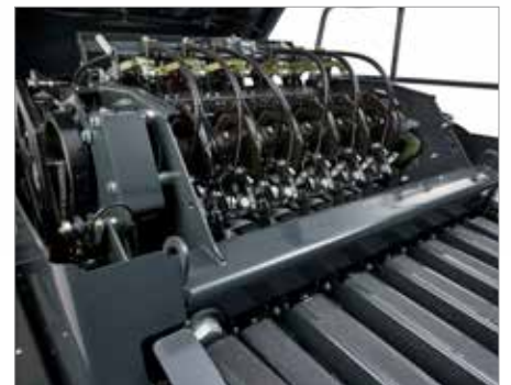
4. Doppelknotersystem mit serienmäßiger elektronischer Überwachung
