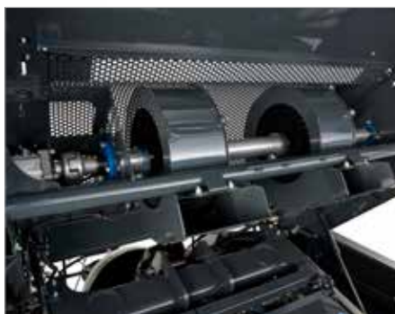
6. Turbinengebläse für Knoterreinigung
