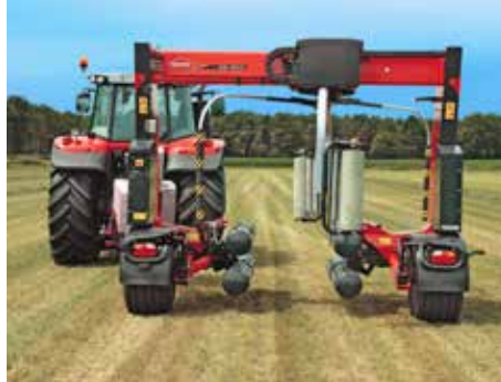
Der Wickler lässt sich aus der Transportposition mit 2,50 m in die Arbeitsposition mit 4 m Breite klappen
