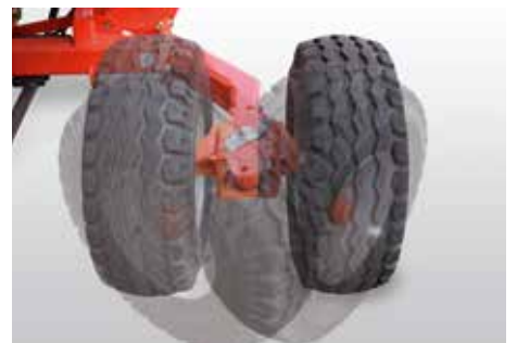
Zum Straßentransport kann das rechte Rad nach innen eingeklapppt werden. Einklappung des linken Rades auf Wunsch
