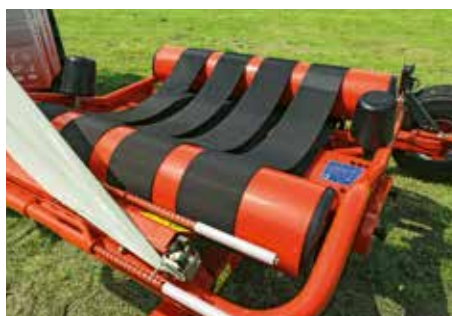
Vier gleich breite Endlosriemen
