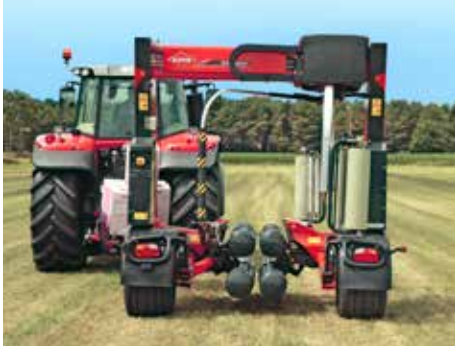
Der Wickler lässt sich aus der Transportposition mit 2,50 m in die Arbeitsposition mit 4 m Breite klappen
