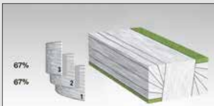
Der Ballen wird mit 3 Lagen bei 67 % Überlappung umwickelt
