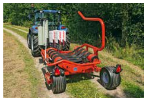
Geringere Transportbreite durch Einklappung eines Rades
