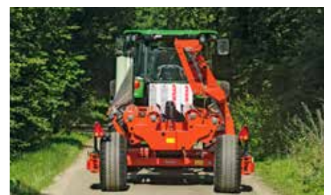
Afin de réduire la largeur de la machine lors du transport sur la route, les roues peuvent être repliées vers l'intérieur. Un repliage hydraulique est disponible en option
