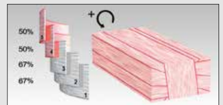
Application des 2 dernières couches avec 50 % de recouvrement
