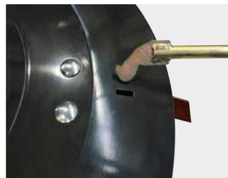
4. Messerwechselsystem mit Sonderwerkzeug und Messerhalter
