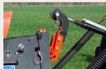
Flexibler FLEXTOP-Oberlenker (nur für starren Anbaubock geeignet)
