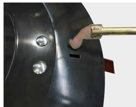
4. Messerwechselsystem mit Sonderwerkzeug und Messerhalter
