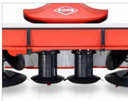
5. Serienmäßige Schwadscheiben für eine schmale Schwadablage
