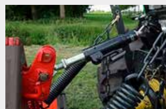
FRONTFLEX-Teleskop-Oberlenker (nur für schwenkbaren Anbaubock geeignet)
