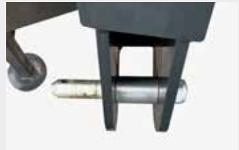
Goupilles de liaison pour ajuster le chevauchement de 75 mm
