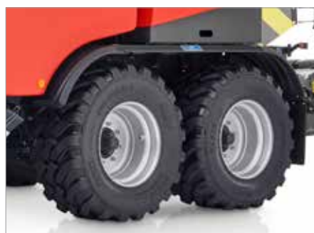
9. XL-Tandemachse mit Bereifung 500/60R22.5
