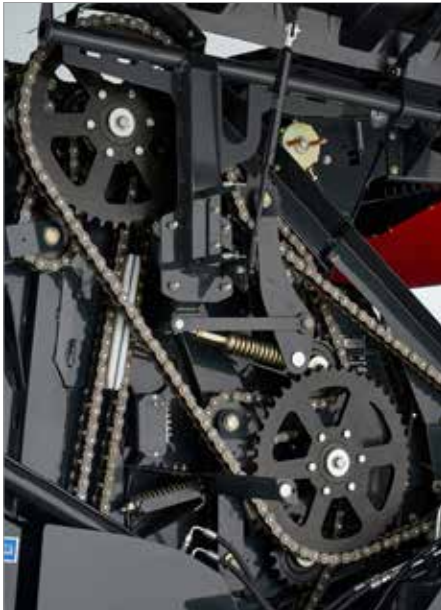
1. Robuster Antrieb mit hochwertigen IWIS-Ketten
