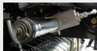
Automatische Zentralschmierung von BEKA-MAX
