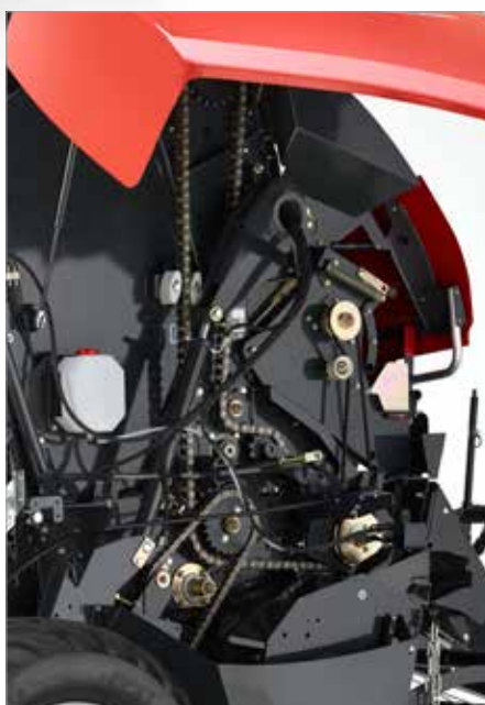
6. Robuster Antrieb mit hochwertigen IWIS Ketten (1¼-Zoll)
