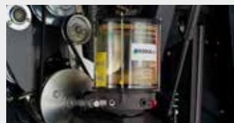
Zentralschmierung mit 4 kg Vorrat
