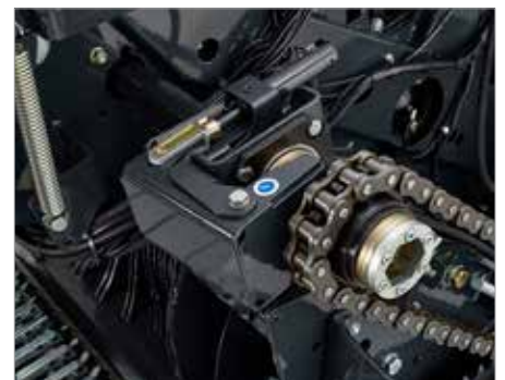
4. Serienmäßige hydraulische Rotorentkopplung
