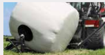
Ballendreher (legt Ballen auf flacher Seite ab)
