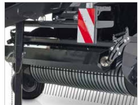
4. Gefederter Rechzinken und schwerer Rollenniederhalter (Ø 217 mm) für eine bessere Vorverdichtung und besseren Gutfluss
