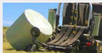
Ballendreher (legt Ballen auf flacher Seite ab)
