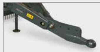
Zugöse 40 mm oder Kugelkopfkupplung 80 mm (K 80)
