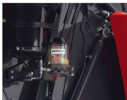
10. Serienmäßige automatische BEKA-MAX Zentralschmierung
