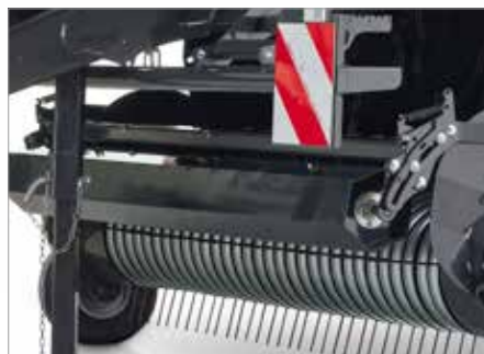
5. Gefederter Rechzinken und schwerer Rollenniederhalter (Ø 217 mm) für eine bessere Vorverdichtung und besseren Gutfluss
