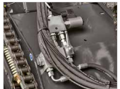
5. DROPFLOOR (absenkbarer Förderkanalboden) aus der Kabine (optional bei OPTIFEED)
