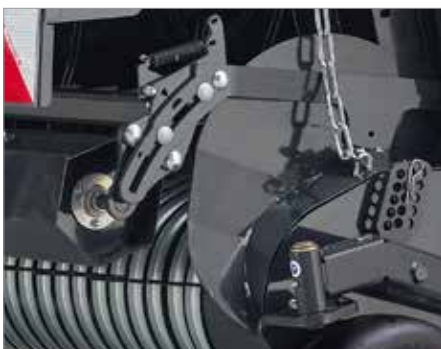
4. Federbelastetes Pick-up Prallblech und schwerer Rollenniederhalter (Ø 217 mm) für bessere Vorverichtung und optimierten Gutfloss
