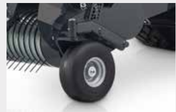
Nachlaufende Pick-up Tasträder mit Nonstop-Luftkammer-Reifen
