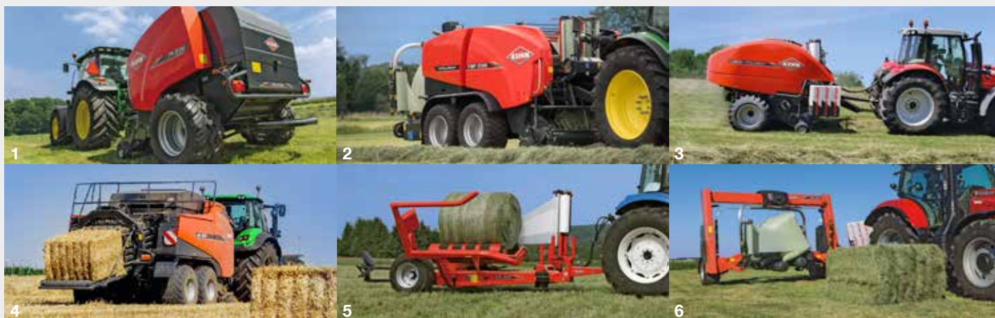
1. Presses à chambre fixe - 2. Combinés presses-enrubanneuses - 3. i-BIO+ - 4. Presses haute densité - 5. Enrubanneuses pour balles rondes - 6. Enrubanneuses pour balles rondes et rectangulaires
