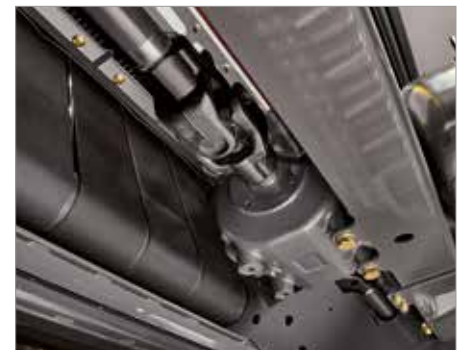
7. Arbres d'entraînement avec joints de cardan intégrés
