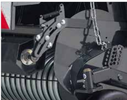
4. Peignes régulateurs actifs et tasse andain de grand diamètre (Ø 217 mm) pour une meilleure précompression et un meilleur flux de fourrage
