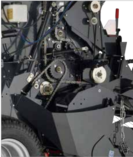
1. Transmission robuste avec chaînes IWIS de qualité supérieure
