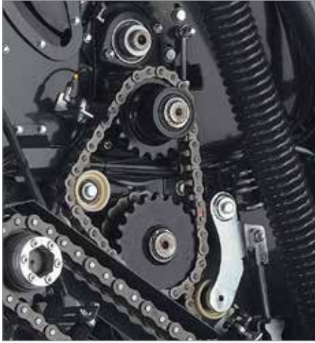
1. Le deuxième rouleau d'entraînement garantit un entraînement sûr des courroies quelles que soient les conditions de culture
