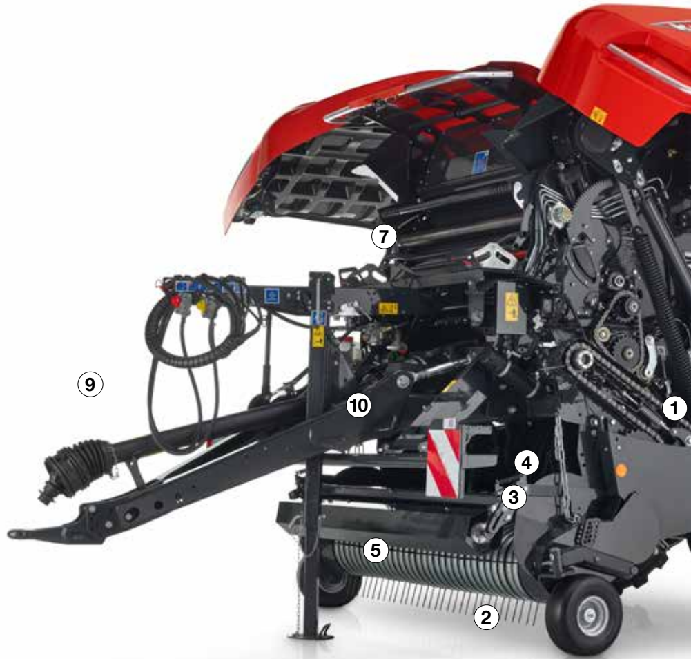
1. Le deuxième rouleau d'entraînement garantit un entraînement sûr des courroies quelles que soient les conditions de culture
