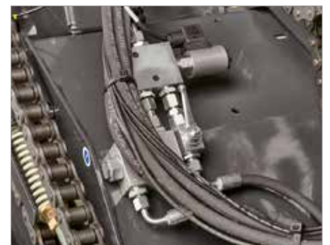
5. Contrôle des couteaux / de la trappe escamotable DROPFLOOR séparé, actionnés depuis la cabine du tracteur (en option pour OPTIFEED)
