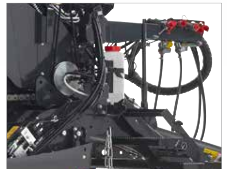
6. Système de lubrification continue BEKA-MAX
