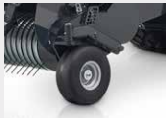
Roues de jauge de pick-up pivotantes et semi-pneumatiques
