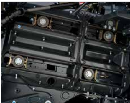
2. Hochbelastbar - geschmierte Kolbenrollen
