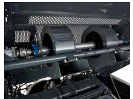
6. Turbinengebläse für Knoterreinigung
