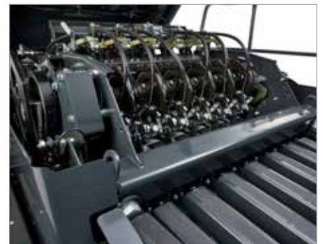
4. Doppelknotersystem mit serienmäßiger elektronischer Überwachung
