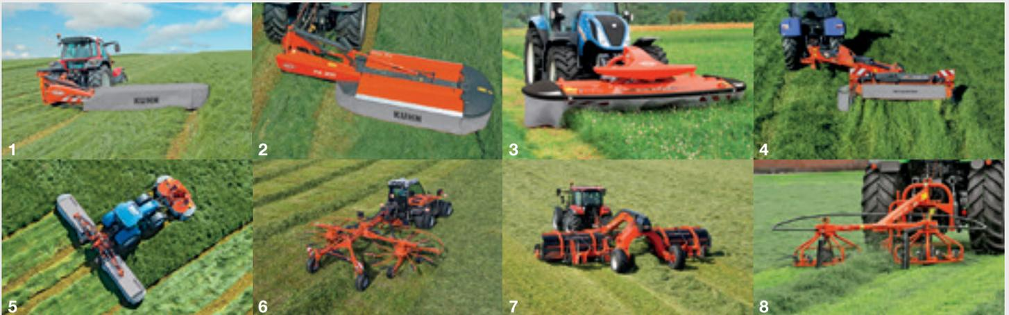
1. Heck-Scheibenmäher - 2. Heck-Trommelmäher - 3. Front-Scheibenmäher und Mähaufbereiter - 4. Heckmähaufbereiter - 5. Dreifach-Mähkombinationen - 6. Kreiselschwader - 7. Bandschwader - 8. Universalheumaschinen
