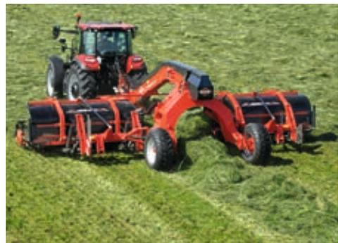
Grâce au boîtier de commande KMM 20, la vitesse des tapis et le sens de rotation des tapis peuvent être paramétrés aisément depuis la cabine. La largeur de ramassage et de transport est de 3 m, la largeur de travail – andains compris – d'env. 4,4 m. Un distributeur à effet simple avec retour libre suffit pour l'entraînement, le poids s'élève à env. 1140 kg.
