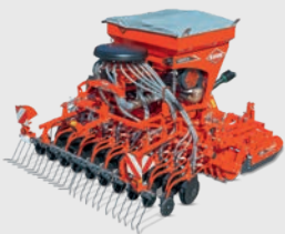
VENTA 330 + HR 304 Pneumatische Aufbausämaschine
