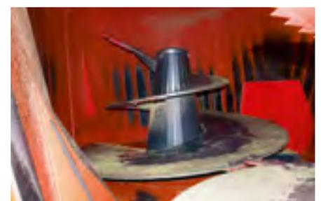
Die Mischschnecken verjüngen sich nach oben und weisen im oberen Viertel die doppelte Steigung auf.
