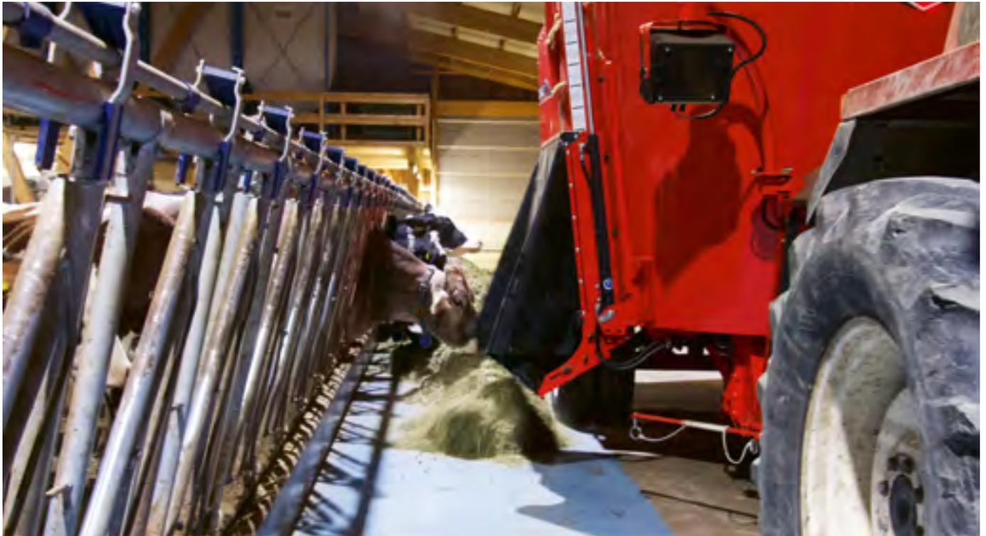
Der Futtermischwagen «Profile 18.2 DM» von Kuhn mit dem seitlichen Direktauswurf konnte im Test überzeugen, ist aber auch mit optionalem Förderband-Austrag erhältlich. Bilder: Roman Engeler
