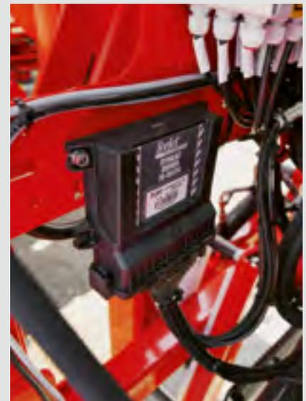
Die «Autospray»-Funktion wird durch eine «PWM»-Magnetspule gewährleistet, die die Öffnung jedes Düsenhalters steuert (oberes Bild) und von einem Bordcomputer am Parallelogramm des Gestänges gesteuert wird (unteres Bild).
