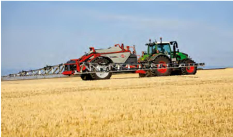
Die neue Anhängespritze «Karan» kann mit Stahl- oder Aluminiumgestängen von 18 bis 45 m ausgestattet werden. Bild: Roman Engeler
