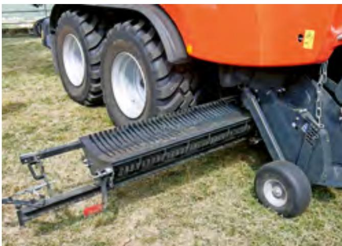
Mit dem Schneidwerk «Opticut 33» und seinen 33 Messern lassen sich theoretische Schnittlängen von 34 mm erreichen – vorerst für die Presswickelkombination «VBP 7100» erhältlich. Bild: Roman Engeler
