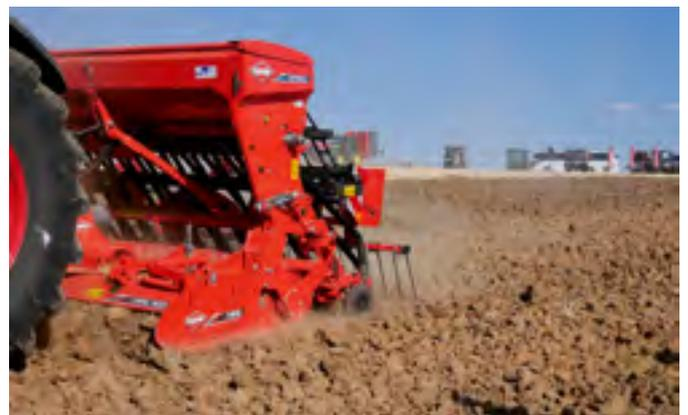
Für die 3 m breite mechanische Aufbau-Sämaschine «Sitera» sind nun auch Doppelscheiben-Säschare erhältlich. Bild: Roman Engeler
