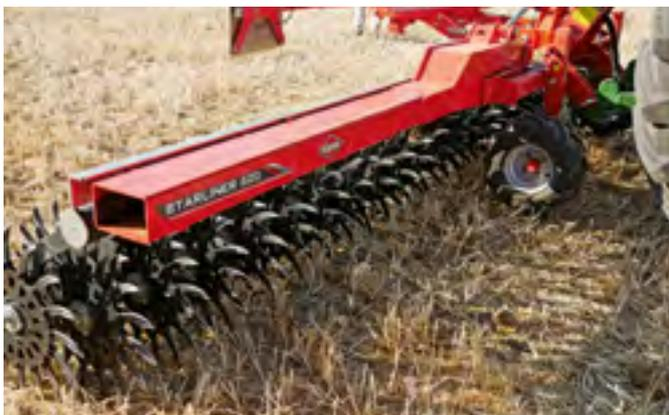
Die Rotorhacke «Starliner» ergänzt bei Kuhn das Programm für die mechanische Unkrautbekämpfung. Bild: Roman Engeler
