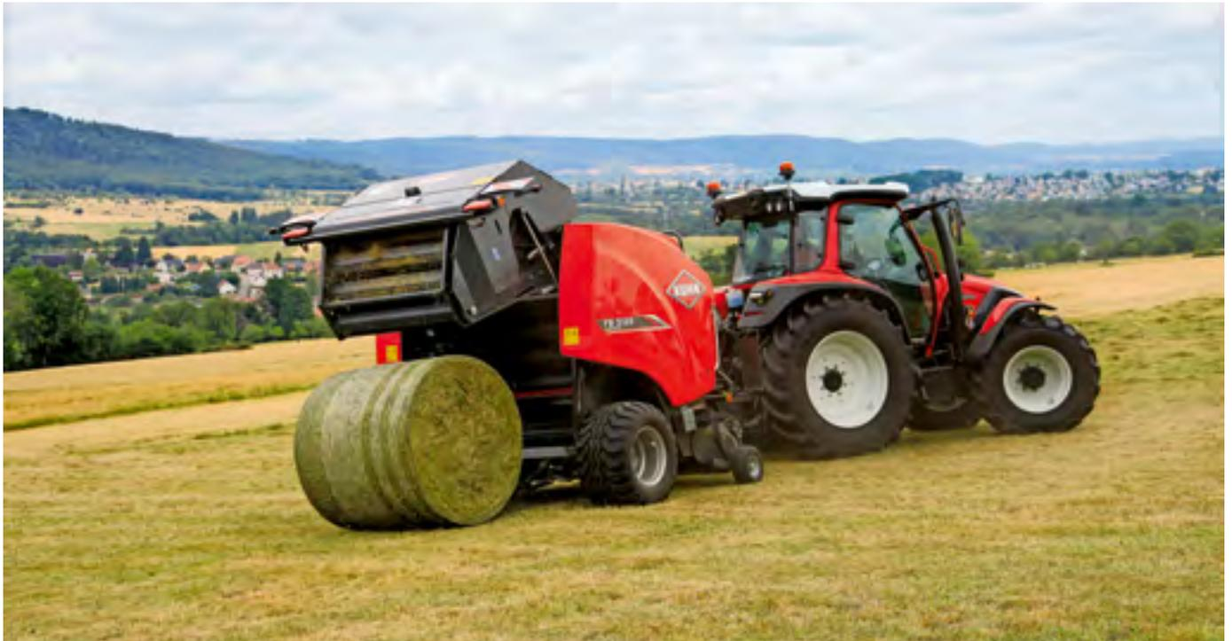
Mit der Festkammer-Rundballenpresse «FB 3125» bringt Kuhn eine relativ einfach gehaltene Solo-Pressen auf den Markt, die mit 18 profilierten Presswalzen die Ballen formt. Bild: Johannes Paar
