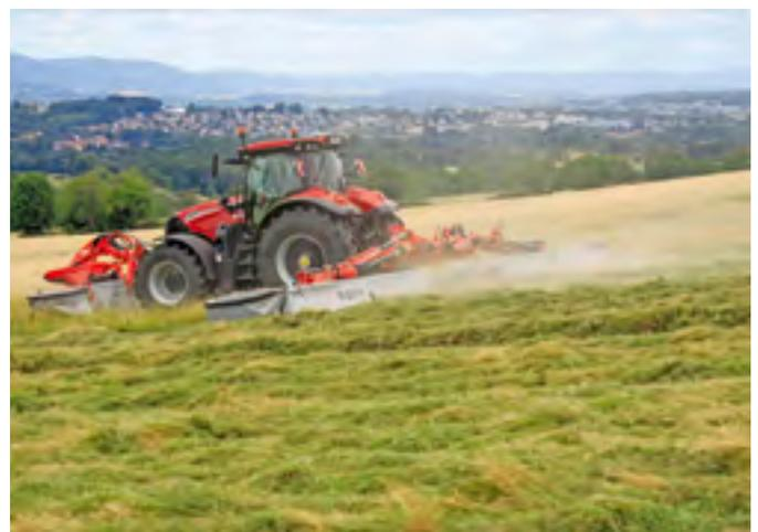
Eine Exklusivität von Kuhn: Das Grossflächenmäherwerk «GMD 15030» mit einer Arbeitsbreite von 14,5 m, bestehend aus vier in einer Flucht ausgerichteten Mäheinheiten. Bild: Johannes Paar
