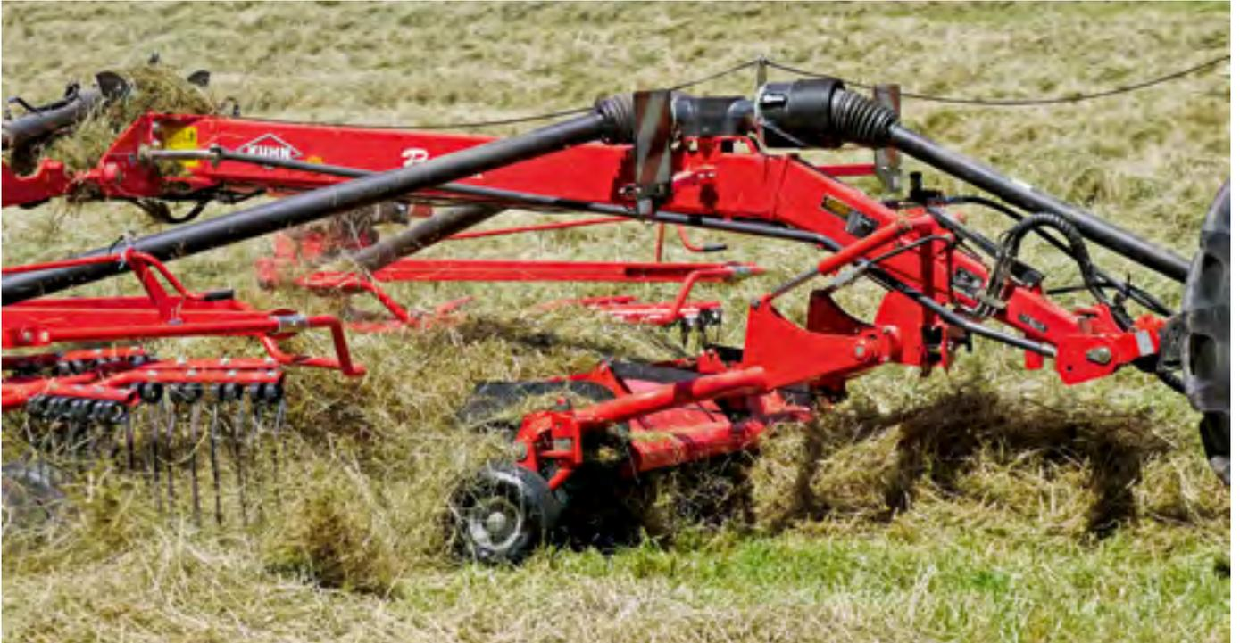
Das von Kuhn patentierte, hydraulisch angetriebene «Air Pick-up» am Mittelschwader «GA 8131 CL» arbeitet auf einer Breite von 1,80 m und ist vor den Kreisel positioniert. Bilder: Heinz Röthlisberger
