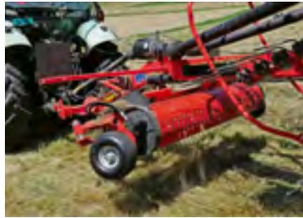
Die mittige Aufhängung des Pick-up erlaubt grosszügige Pendelwege quer zur Fahrtrichtung, höhenverstellbare und schwenkbare Tasträder an den Seiten übernehmen die Konturenführung.
