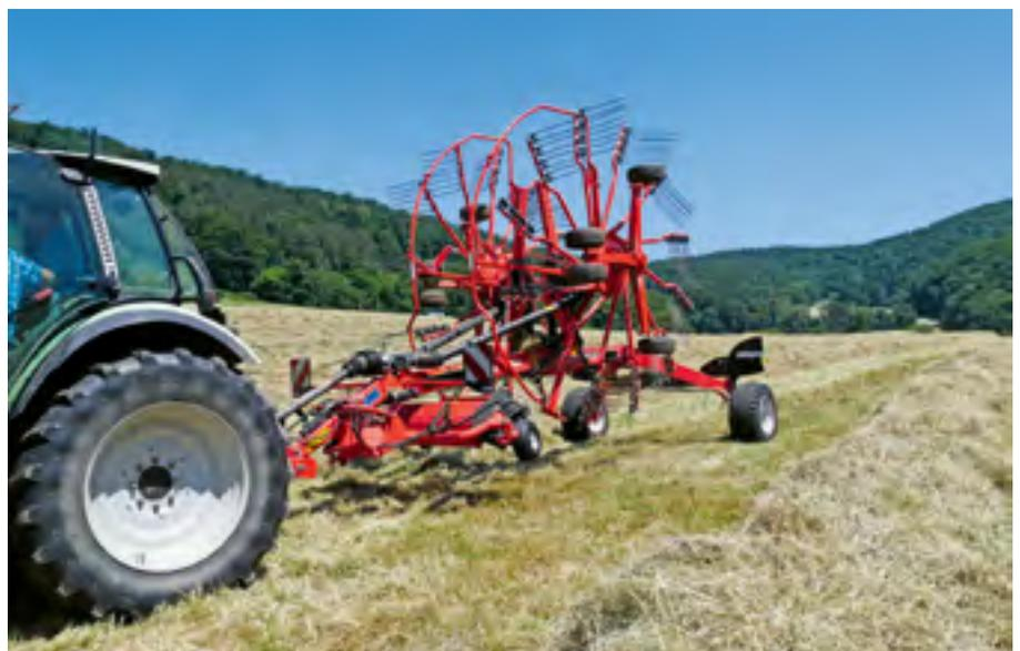
Sowohl am Vorgewende als auch beim Kreiselaushub für die Transportstellung wird das Pick-up automatisch ohne Zeitverlust mit ausgehoben.
