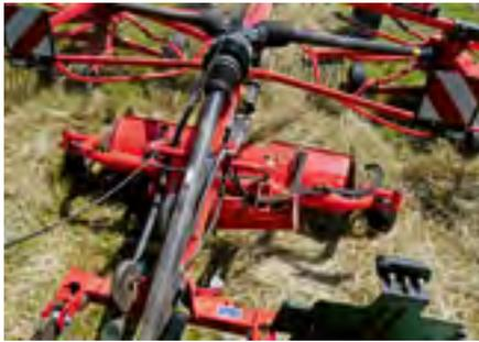
Das Pick-up mit dem Leitblech sorgt dafür, dass das von den Kreisel nicht erfasste Futter vom Boden angehoben und gelockert wird. So entstehen luftige und homogene Mittelschwade.
