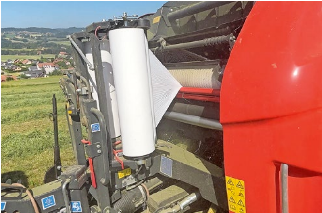
Das Wickelsystem verwendet zwei Folienrollen («Twin-System»), die sich während des Wickelvorgangs horizontal drehen, oder alternativ eine herkömmliche Netzrolle.
