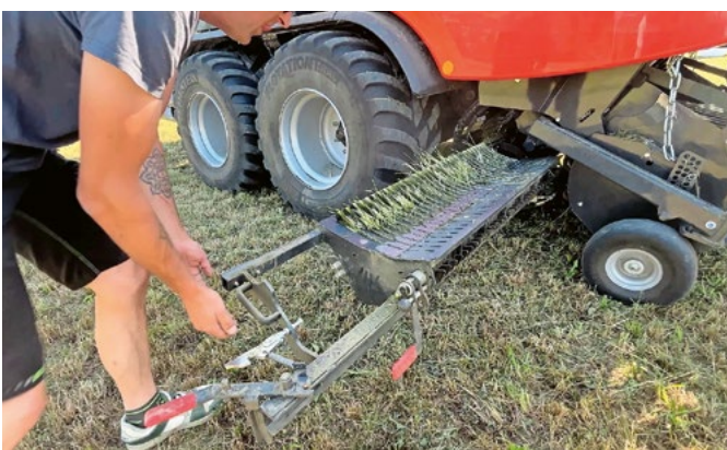
Dank einer Schublade ist die Kassette mit 33 Messern für den Bediener leicht zugänglich.
