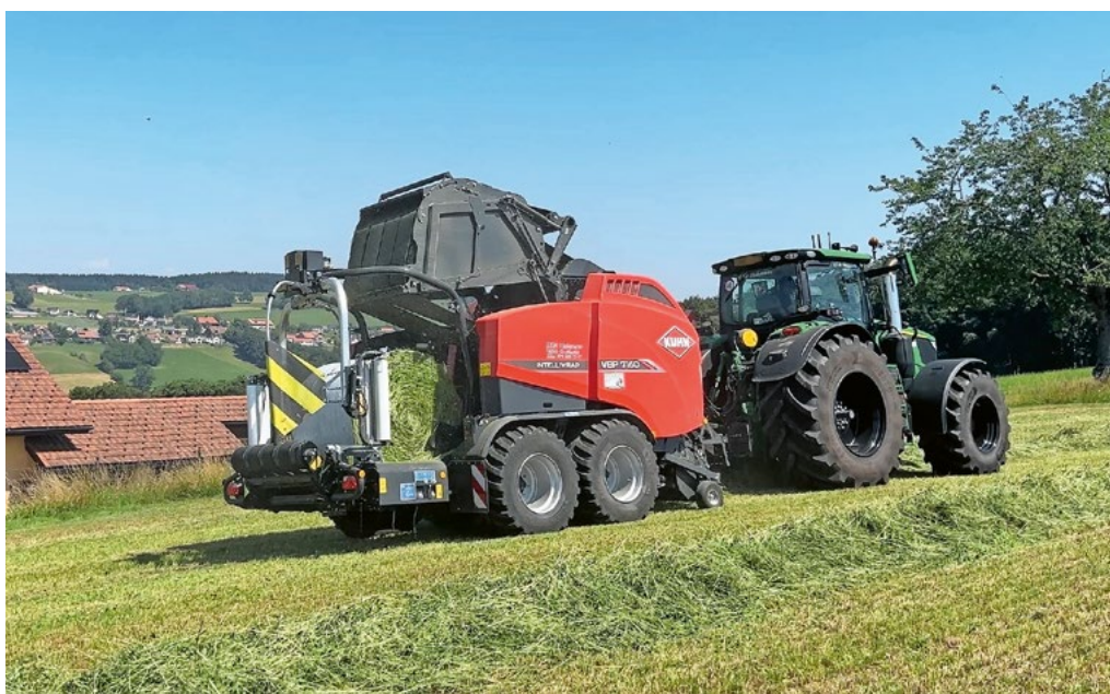
Die «VBP 7160» mit «Opticut 33»-Schneidwerk von Lohnunternehmer John-David Flühmann aus St-Martin (FR) im Einsatz. Mit der Messergruppenschaltung kann zwischen 0, 8, 16, 17 oder 33 Messern ausgewählt werden. Bilder: Matthieu Schubnel
