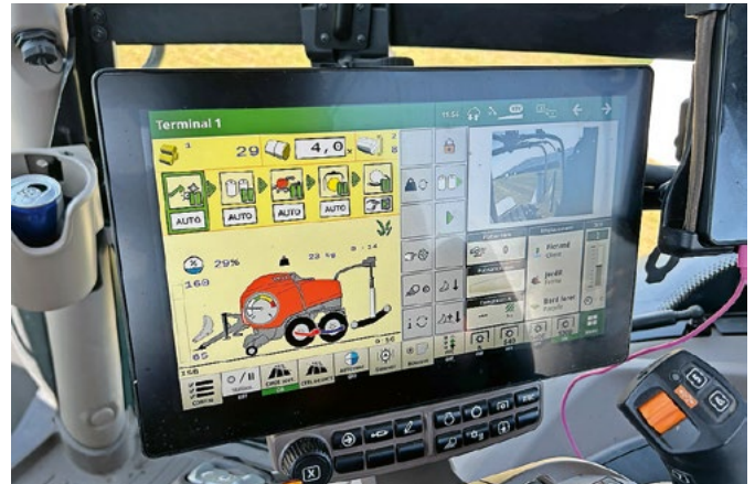
Die Isobus-Steuereinheit verfügt über diverse Konfigurationsmenüs zur Optimierung des Betriebs von Ballenpresse und Wickelmaschine.
