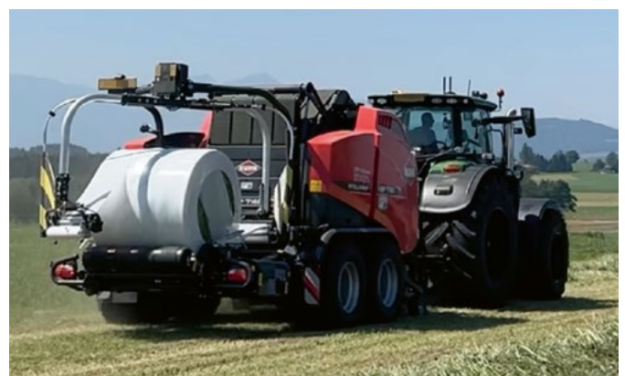
Während der 3D-Bindung rotieren die Rollen horizontal, binden den Ballen und kehren dann in ihre vertikale Position zurück.
