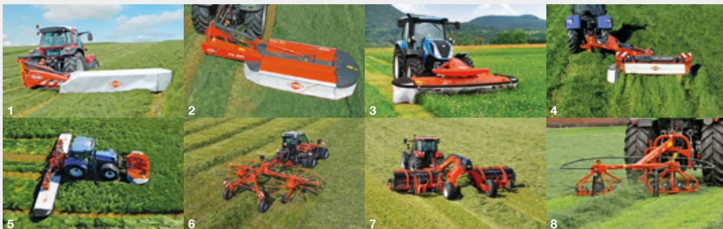
1. Faucheuses à disques arrière - 2. Faucheuses à tambours arrière - 3. Faucheuses et faucheuses-conditionneuses frontales - 4. Faucheuses-conditionneuses à disques arrière - 5. Faucheuses et faucheuses-conditionneuses triples - 6. Giro-andaineurs - 7. Andaineurs à tapis - 8. Faneurs andaineurs
