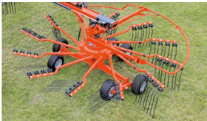
Le choix de l'essieu tandem sous le rotor avec 6 roues au plus proche des fourches vous garantit un suivi optimal du terrain.
