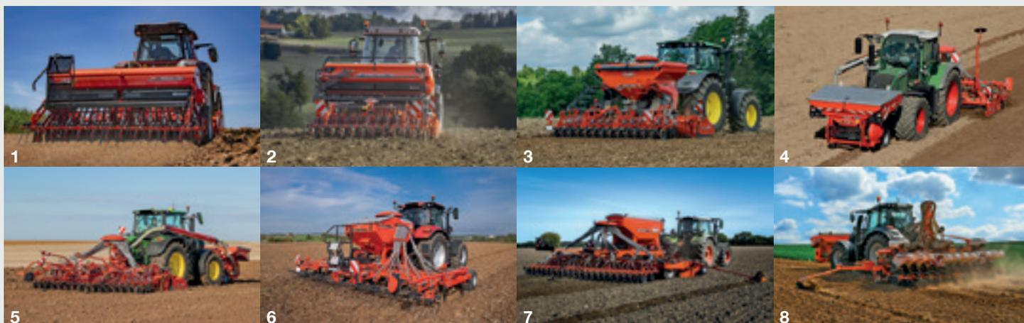
1. Mécaniques portés - 2. Mécaniques intégrés - 3. Intégrés pneumatiques - 4. Avec trémie frontale - 5. Repliables pneumatiques
