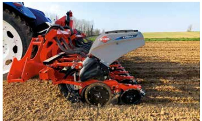
La coupure de rangs par GPS s'opère par l'arrêt du moteur sur chaque rang, de manière très réactive et sans perte de graine. Cela assure une économie de semence non négligeable à l'utilisateur. En s'affranchissant du patinage des roues d'entraînement lié aux conditions de sol, l'entraînement électrique assure un respect parfait de la dose de semences. L'entretien de la machine est également réduit à court terme avec moins de graissage en saison ainsi qu'à long terme avec moins de pièces d'usure.
