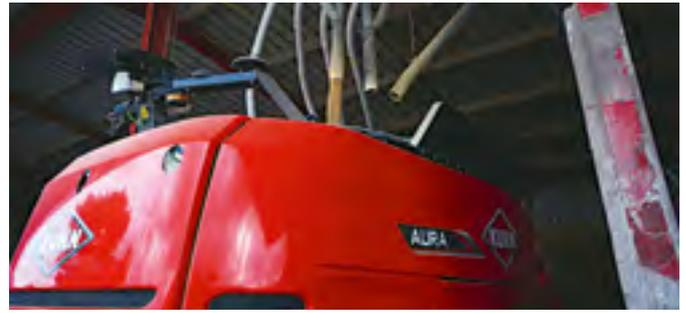
Les composants comme les concentrés et les minéraux sont incorporés par le haut, par des flexibles et des vis doseuses.
