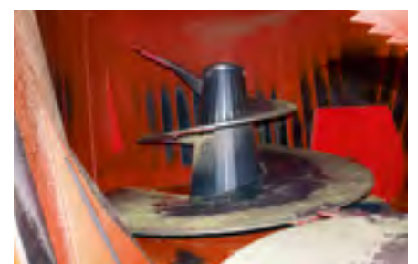
Les vis de mélange se rétrécissent en partie supérieure et présentent une double pente à ce niveau.
