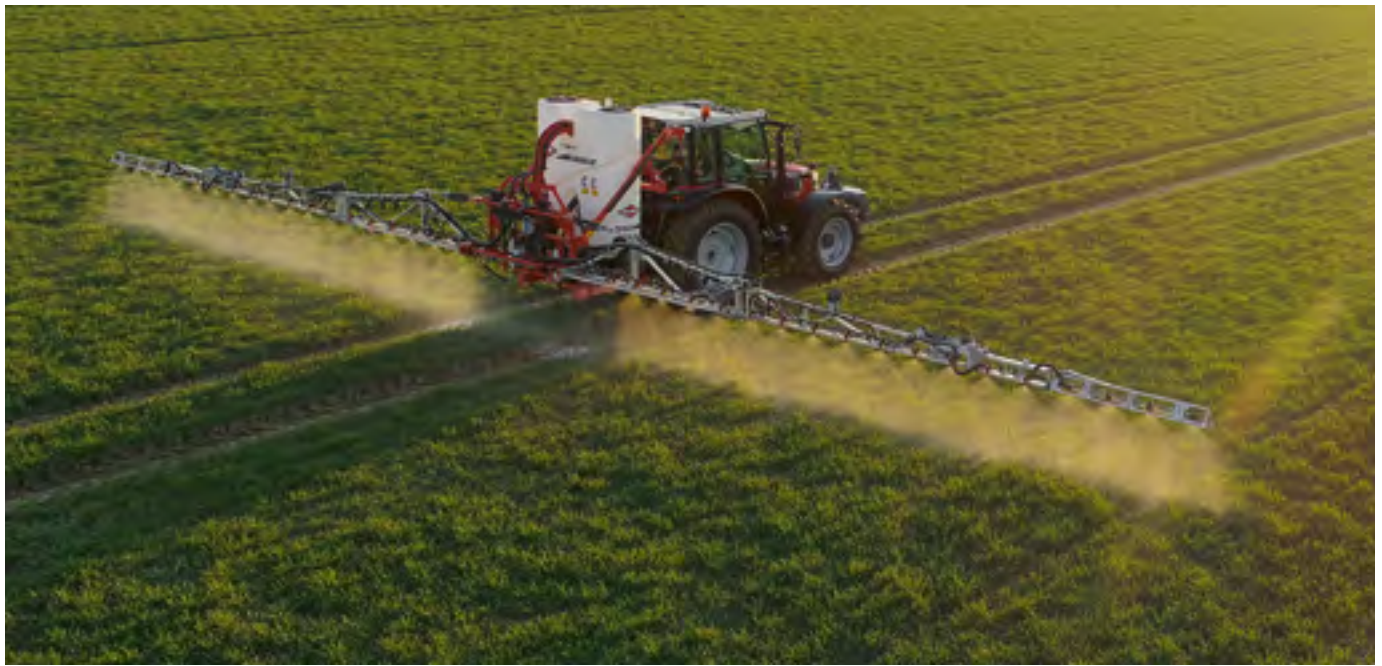
Le pulvérisateur Kuhn «Deltis 2» dispose d'une fonctionnalité de rinçage assisté utilisable depuis la cabine et compatible avec les exigences de l'Office fédéral de l'agriculture. Photo: Kuhn
