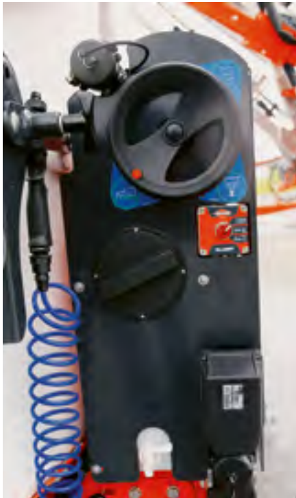
Le tableau de mise en œuvre «Diluset+» (ici sur un appareil porté «Deltis 2») comprend une vanne de refoulement manuelle (en haut) et une vanne d'aspiration motorisée (en bas). Photo: Matthieu Schubnel
