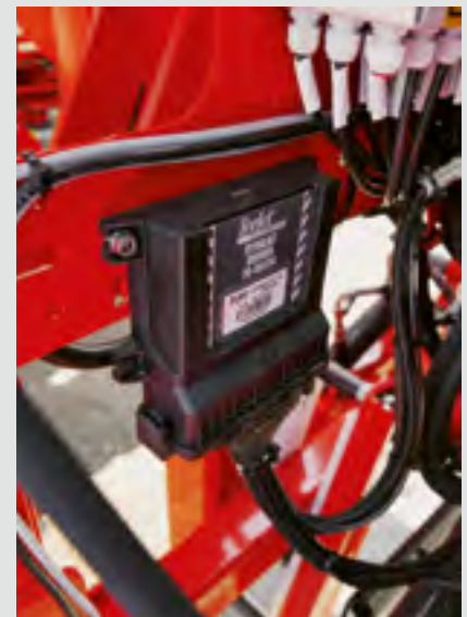
La fonction Autospray est assurée par un solénoïde PWM contrôlant l'ouverture de chaque porte-jet (photo du haut) et piloté par un calculateur embarqué au niveau du parallélogramme de la rampe (photo du bas). Photos: Matthieu Schubnel
