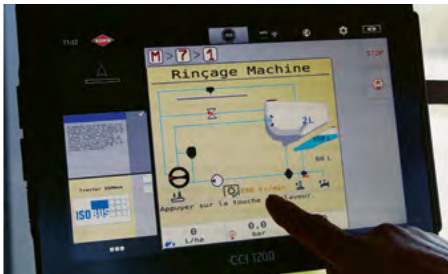
Le programme associé à la version «Diluset+» guide le chauffeur en cabine à travers les étapes successives du rinçage et matérialise le déroulement des opérations sur l'interface.
