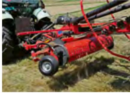
**La suspension centrale du pick-up rend possible des courses généreuses à la fois verticalement et transversalement. En outre, les roues de jauge latérales pivotantes assurent un bon suivi des contours.**
