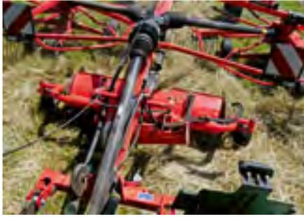
**Le pick-up avec tôle de guidage intervient sur le fourrage qui n'a pas été ramassé par les rotors en le soulevant et en l'aérant. L'andain central est de la sorte formé de manière homogène et aérée.**
