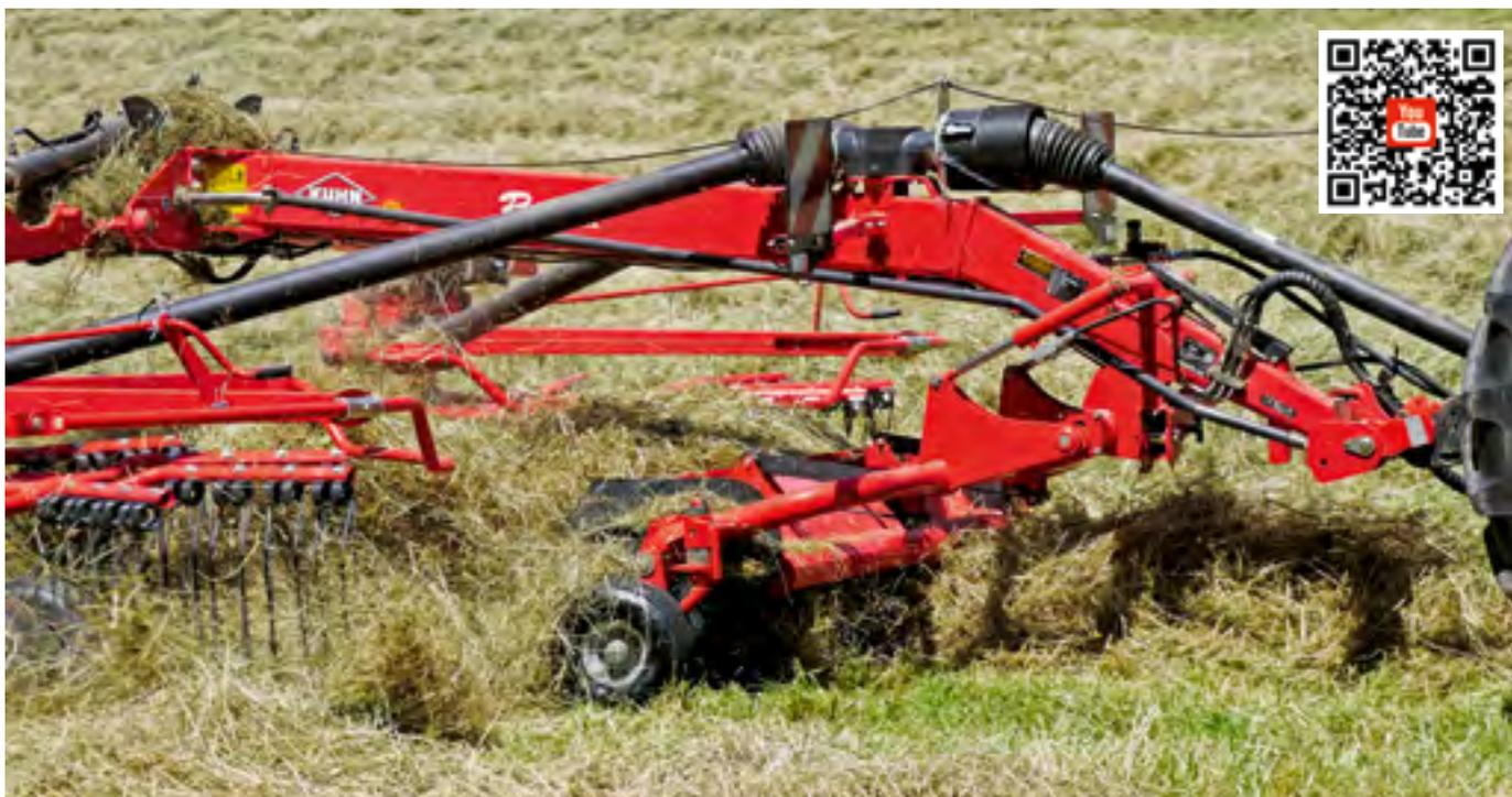
Kuhn associe son système breveté «Air Pick-up» à l'andaineur «GA 8131 CL». Le pick-up positionné au centre, devant les rotors, travaille sur une largeur de 1,80 mètre. Photos: Heinz Röthlisberger
